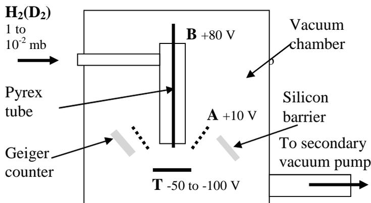
**Figure 3. Proton (deuterium) generator.**
